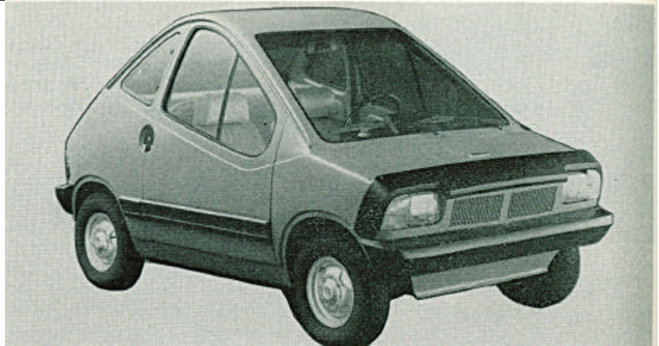
Prototipo della vettura elettrica cittadina Z1/23 della FIAT (2 posti, 80 km/h, autonomia 60 km). La vettura non è stata commercializzata ma ha denotato l'interesse dell'industria verso la trazione elettrica. La FIAT ha poi lavorato ad un'altra vettura elettrica, la ECOS, assieme al carrozziere Pininfarina.
