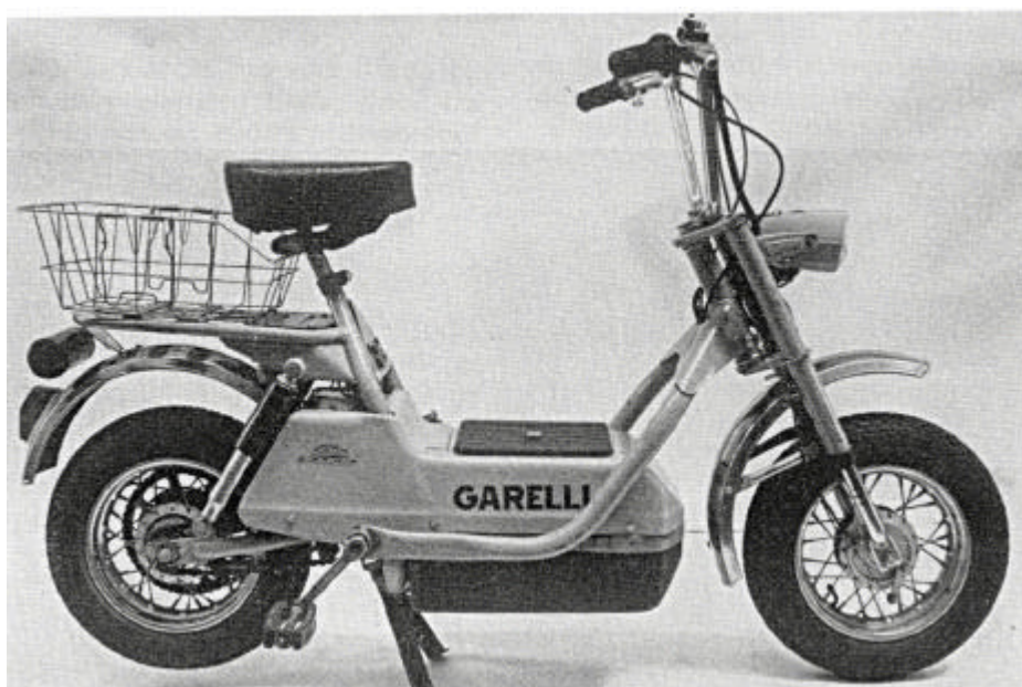
Il ciclomotore elettrico KATIA della Garelli è tra i pochi veicoli elettrici che sono stati disponibili a livello commerciale. Aveva una velocità di circa 35 km/h ed un'autonomia di una quarantina di chilometri
