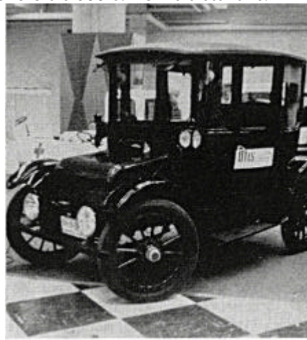
L'American Baker del 1915 aveva una velocità massima di oltre 40 km/h ed un'autonomia di circa 65 km
